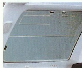
リヤクォーターガラスアンテナ AM/FM (FMダイバシティ対応)、TV対応。
