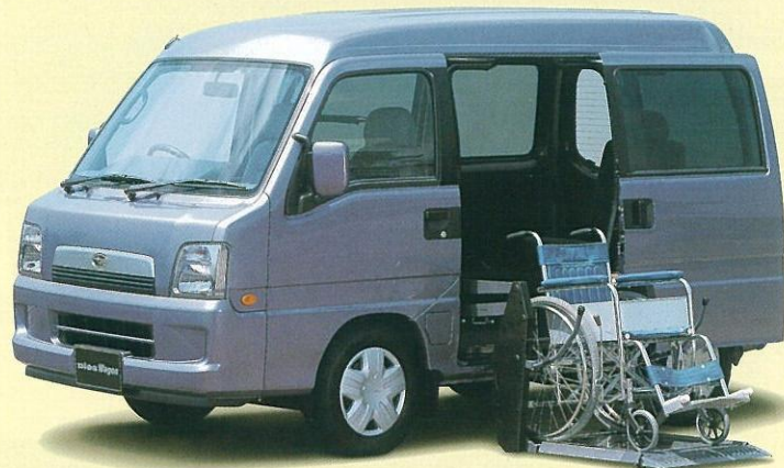
電動リフター 車いすをプラットフォームに載せ、スイッチひとつで昇降・収納の操作が可能。また、 後席アームレストも装備し、介護する方にとっても快適な電動リフターです。
