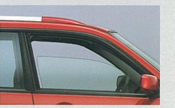
UVカットガラス 紫外線をカット。冷房効果も高めます。CROSS SPORTS, XT, X20はフロント・フロントドア・リヤドアに標準装備。Xはフロントのみ。
