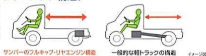
サンバーのフルキャブ・リヤエンジン構造 一般的な軽トラックの構造 イメージ図
