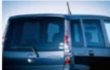
UVカット機能付濃色ガラス (リヤドア・リヤクォーター・リヤゲート)
